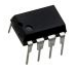
Optocoupler DC-IN 1-CH Trans W/Base DC-O Код товара RS 710-4907 Парт-номер производителя SFH6136-X009T
