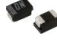
Vishay 2.2µF Tantalum Capacitor 10V dc, TMCP Series Код товара RS 188-2449 Парт-номер производителя TMCР1A225KTRF
