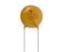
Vishay Single Layer Ceramic Capacitor (SLCC) 470pF 500V ac ±20% Y5U Dielectric, AY1, Through Hole +125°C Max Op. Temp. Код товара RS 183-7389 Парт-номер производителя AY1471M31Y5UC63L0
